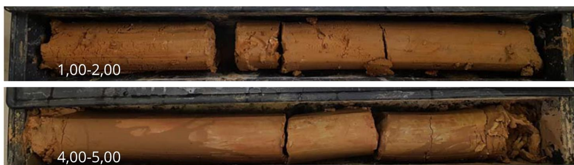
Figure 4. Vues des carottes de matériaux argileux prélevés lors du sondage.
